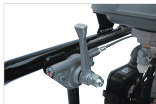
Leva acceleratore originale Mikasa in alluminio pressofuso
