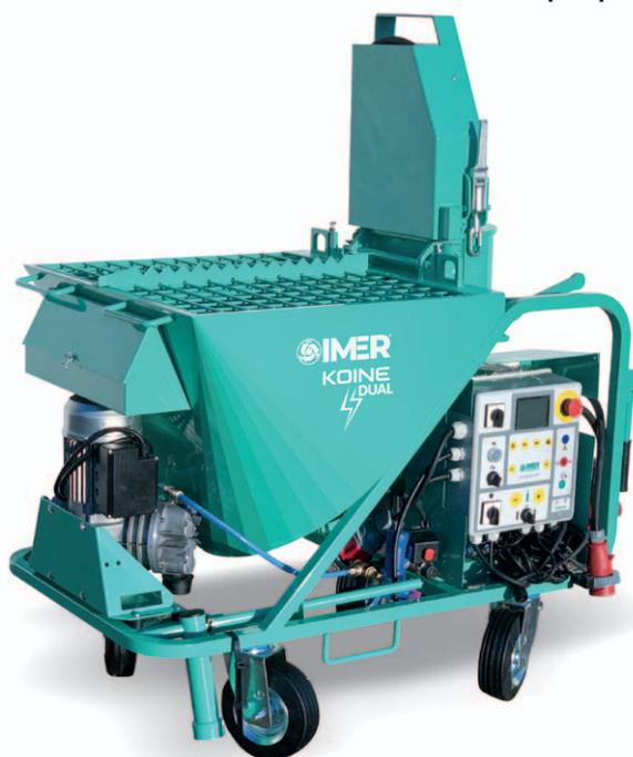
**KOINE DUAL** è una pompa miscelatrice a ciclo continuo di **NUOVA GENERAZIONE**, adatta al pompaggio/spruzzatura dei materiali premiscelati asciutti. Velocità variabile (6 velocità selezionabili). **SMART LINK TECHNOLOGY**: la macchina si configura automaticamente in base all'alimentazione disponibile (**monofase o trifase**) e alla potenza elettrica disponibile **da 3 a 8 kW**. **L'INVERTER** ottimizza la gestione dei motori e permette di gestire
