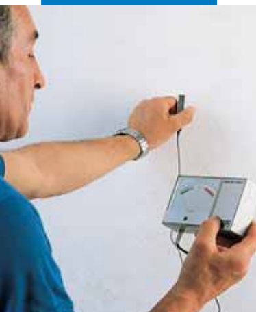
Controllo di umidità del gesso
